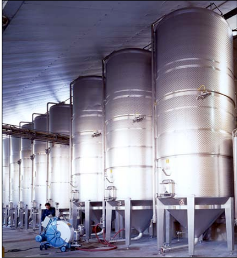
n. 3 da HI. 220 n. 3 da HI. 320, n. 4 da HI. 900 n. 4 da HI. 440.
